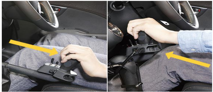
アクセル（手前に引く）ブレーキ（前方に押す）
